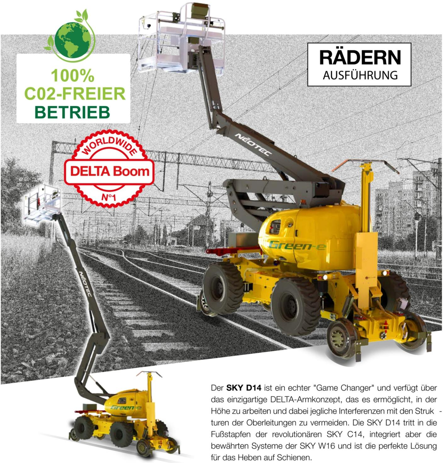
Der **SKY D14** ist ein echter "Game Changer" und verfügt über das einzigartige DELTA-Armkonzept, das es ermöglicht, in der Höhe zu arbeiten und dabei jegliche Interferenzen mit den Strukturen der Oberleitungen zu vermeiden. Die SKY D14 tritt in die Fußstapfen der revolutionären SKY C14, integriert aber die bewährten Systeme der SKY W16 und ist die perfekte Lösung für das Heben auf Schienen.
